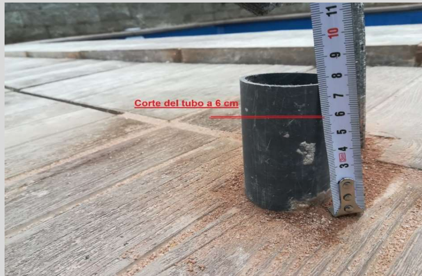
Ilustración 6. Corte del tubo a 6 cm
